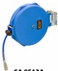
CA-8513A Mangueira em Poliuretano 5mmX8mm(Ø) Comprimento 10Mts. Carcaça em plástico Pressão Máx. 14 kg/cm²
