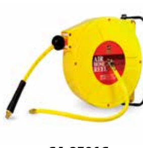
CA-8501C Mangueira em Poliuretano 8mmX12mm(Ø) Comprimento 10Mts. Carcaça em Aço Pressão Máx. 15 kg/cm² Ligação 1/4" Macho
